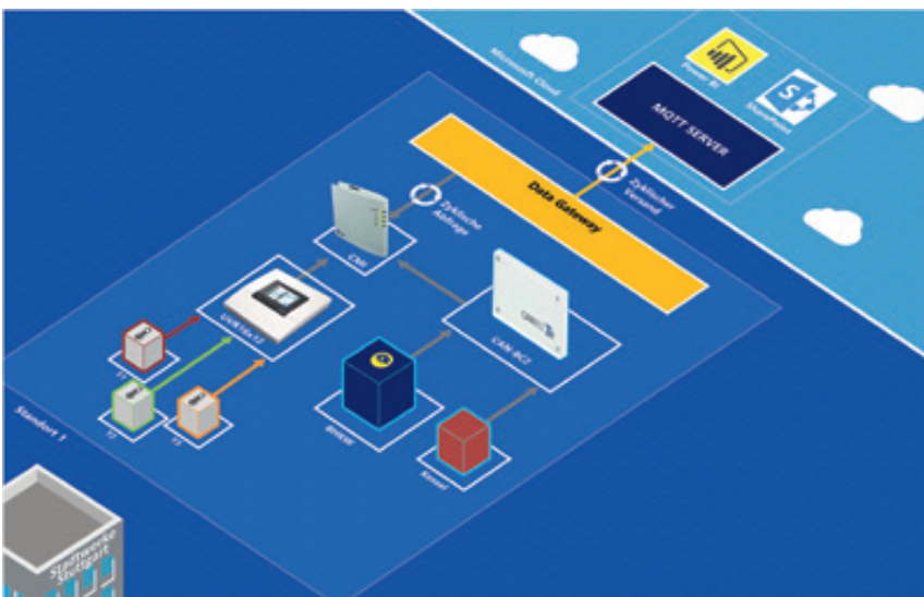
Abb. 1: Die Messdaten aus dem Blockheizkraftwerk – gewonnen mit eigens dafür entwickelter Messtechnik – gelangen via RevPI mithilfe eines Modems zyklisch (jede Minute) über das Gateway an einen MQTT-Server in der Cloud (Azure IoT-Hub).
